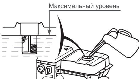
Рис. 6 Максимальный уровень топлива в топливном баке
