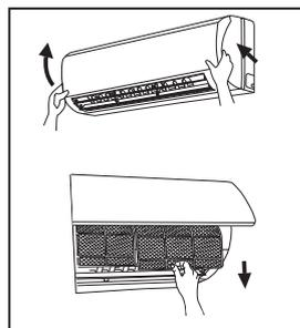
2. Очистите поверхность фильтров. Воспользуйтесь пылесосом или положите фильтр под струю холодной воды. Не пользуйтесь моющими средствами для мойки фильтров, пользуйтесь только холодной водой. Не устанавливайте фильтр на место до тех пор, пока он не высохнет.
