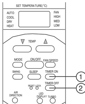
Нажмите кнопку TIMER ON. Отобразятся текущие настройки таймера и будет мигать индикатор. Снова, с перерывом не более 5 секунд, нажмите TIMER ON для изменения времени. Время изменится на 0,5 часа. Если держать клавишу непрерывно, время будет изменяться быстрее. Установите время включения кондиционера.
