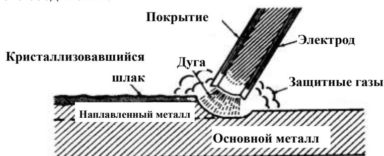
**Рисунок 1.** Сварочная дуга
